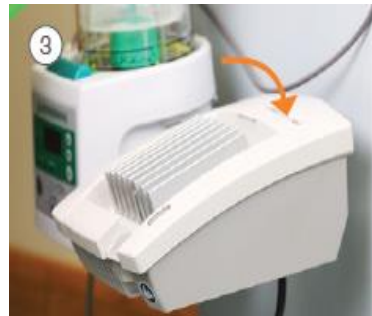
Монтирайте InterCooler на подходящата конзола за InterCooler
