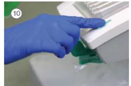
Включете InterCooler с бутона вкл./изкл. Когато системата е настроена и функционира правилно, бутонът светва в зелено
