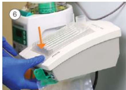
Натиснете касетата надолу, а заключалката напред и проверете дали заключалката е наравно с предната част на корпуса на InterCooler (виж фиг. 1 по-горе)
