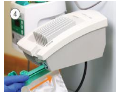
Поставете в InterCooler торбичка за събиране на кондензат.
