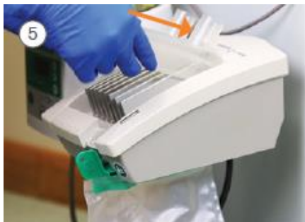
Поставете касетата InterCooler, като внимавате задният ѝ ръб да е под яката на основата на InterCooler
